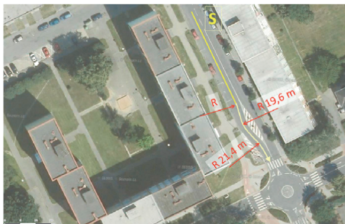
Ryc. 3. Tor najszybszego przejazdu pojazdu na północnym wlocie na mini rondo.
