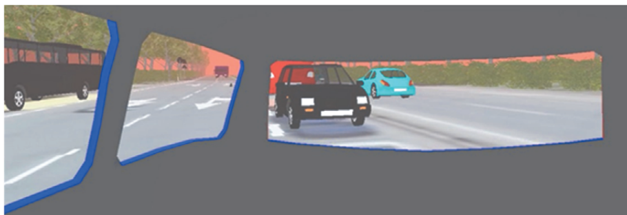
Ryc. 5. Widok, jaki w lusterku wstecznym miała kierująca samochodem w chwili przystępowania do zmiany pasa ruchu (symulacja autora).
