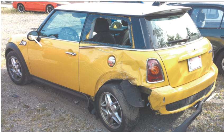
Ryc. 4. Skręcenie tylnego lewego koła. Widoczne jest pofałdowanie tylnego błotnika samochodu Mini, wynikające z efektu rampowego (ze zbiorów autora).
