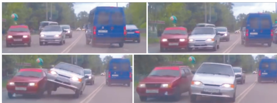
Ryc. 2. Przebieg kolizji z wystąpieniem efektu rampowego (źródło [2]).
