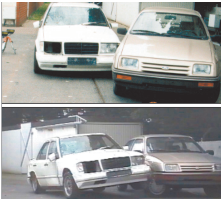
Ryc. 1. Unoszenie się przodu samochodu Mercedes wskutek najeżdżania jego przedniego lewego koła na przednie prawe koło samochodu Ford (na podstawie [1]).
