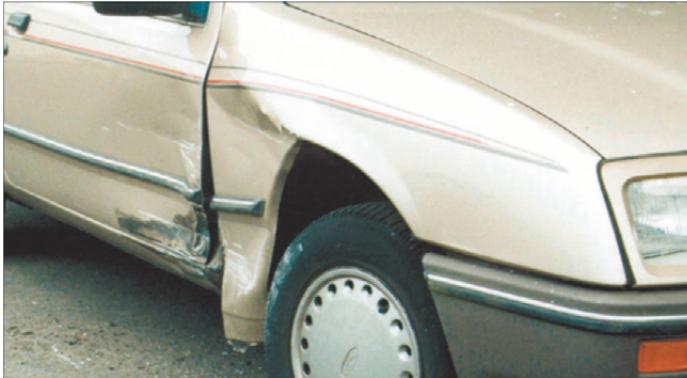
Ryc. 12. Uszkodzenia prawego boku samochodu Ford po zaistnieniu efektu rampowego. Brak śladów kontaktu pojazdów w przedniej części błotnika samochodu uderzonego (na podstawie [1]).
