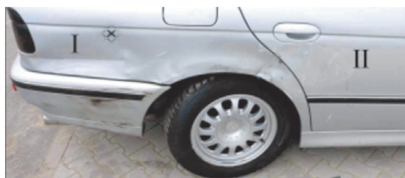
Ryc. 10. Uszkodzenia w postaci wyłobień i punktowych wgnieceń na tylnym błotniku i drzwiach samochodu BMW (na podstawie [1]).
