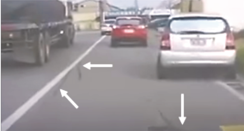
Ryc. 6. Ślady pozostawione na jezdni przez opony samochodu uderzającego (źródło: [2]).
