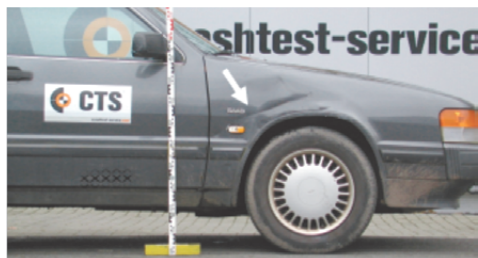
Ryc. 8. Skośny przebieg wgniecenia na błotniku samochodu uderzonego (na podstawie [1]).
