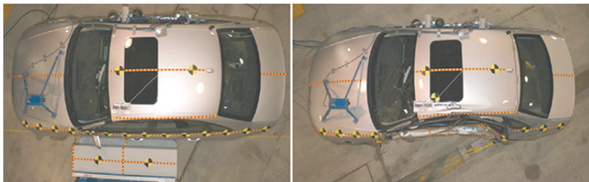
Ryc. 11. Test zderzeniowy – zderzenie boczne samochodu Audi A4 z 2009 r. z odkształcalną, ruchomą barierą [14].
