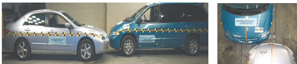
Ryc. 17. Konfiguracja testu zderzenia samochodów Honda Accord z 2004 r. i Dodge Grand Caravan z 1999 r. [14].
