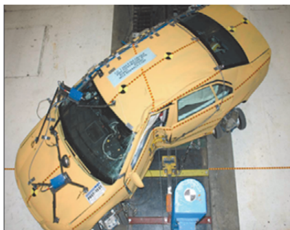
Ryc. 12. Zderzenie boczne samochodu VW Jetta z 2005 r. ze sztywnym słupem (ang. Pole Test) [14].
