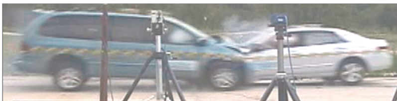
Ryc. 16. Test czołowego zderzenia stojącej Hondy Accord z jadącym z przeciwka Dodge Grand Caravan [14].
