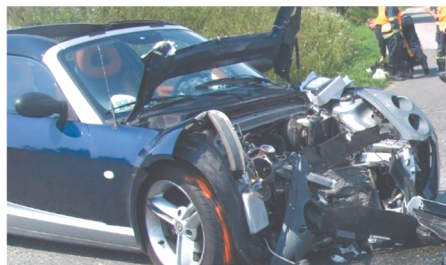
Ryc. 4. Uszkodzenia samochodu – wzorca Smart Roadster po innym, zrekonstruowanym wypadku. Rzeczywista masa tego samochodu (masa w stanie gotowości do jazdy +1 osoba dorosła) wynosiła m = 865 + 75 = 940 kg.
