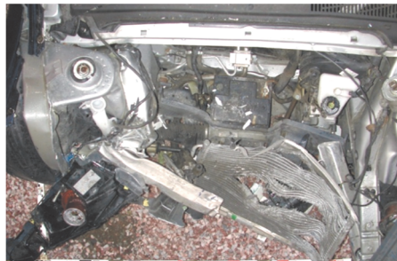
Ryc. 3. Powypadkowe uszkodzenia samochodu Smart Roadster.
