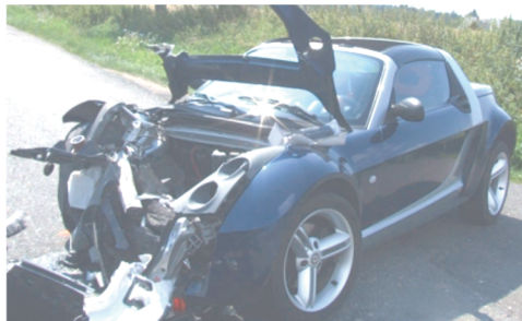
Ryc. 3. Powypadkowe uszkodzenia samochodu Smart Roadster.
