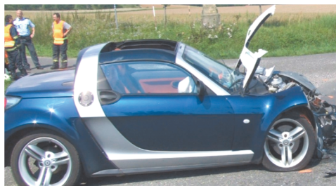
Ryc. 4. Uszkodzenia samochodu – wzorca Smart Roadster po innym, zrekonstruowanym wypadku. Rzeczywista masa tego samochodu (masa w stanie gotowości do jazdy +1 osoba dorosła) wynosiła m = 865 + 75 = 940 kg.
