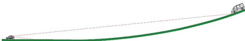
Ryc. 1. Ograniczenie widoczności przez lusterko wsteczne na pochyleniach drogi.
