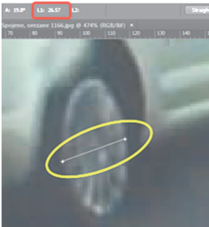
Ryc. 1. Przykład pomiaru średnicy obręczy koła.
