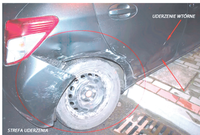
Ryc. 3. Widok uszkodzeń samochodu Toyota Yaris.
