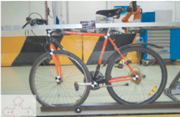
Ryc. 9. Deformacje roweru górskiego po uderzeniu z prędkością ok. 25 km/h w sztywną przeszkodę.
