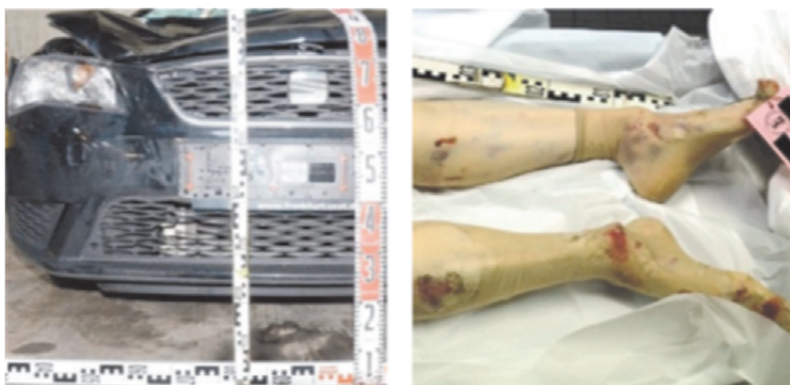
Ryc. 7. Uszkodzenia pojazdu w wyniku potrącenia pieszego (po lewej). Obrażenia dolnych części nóg pieszego po wciągnięciu pod zderzak (po prawej).
