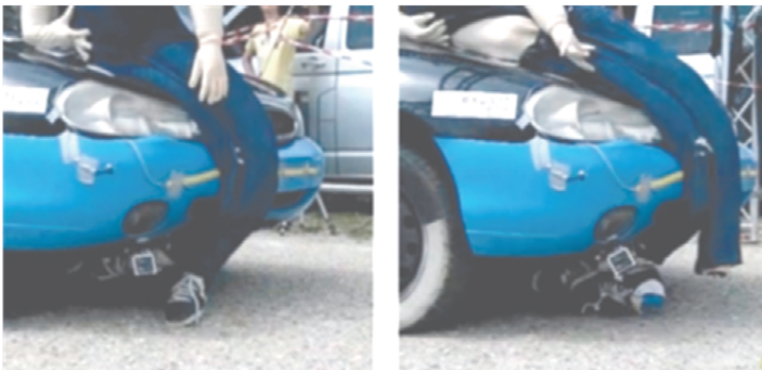
Ryc. 6. Test zderzeniowy – wciągnięcie dolnych kończyn manekina pod zderzak i urwanie lewej stopy.
