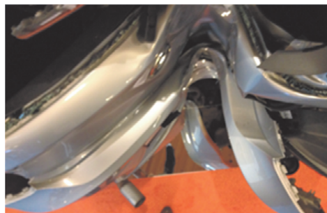
Ryc. 12. Uszkodzenia tylnej części samochodu.
