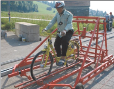
Ryc. 13. Sanki do prowadzenia roweru z manekinem w ruchu przed zderzeniem.
