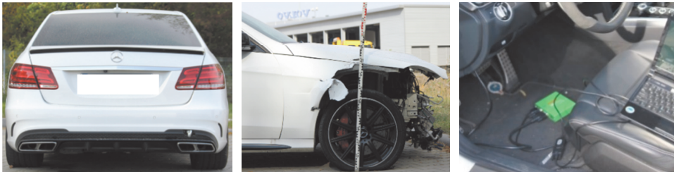
Ryc. 3. Mercedes-Benz (po częściowej naprawie) z podłączonym urządzeniem Bosch CDR do odczytu danych z EDR.
