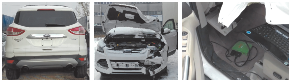
Ryc. 5. Ford Escape z podpiętym urządzeniem Bosch CDR do odczytu danych.
