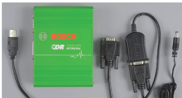
Ryc. 2. Zestaw do pobierania danych zapisanych w rejestratorze EDR Bosch CDR System.
