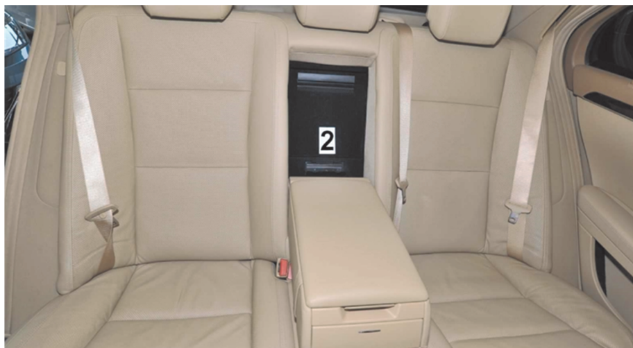
Ryc. 6. Identyfikator VIN umieszczony w samochodzie Mercedes Benz klasy S w sposób niestandardowy – za podłokietnikiem tylnych siedzeń. Prawie nikomu nie przyjdzie do głowy szukać identyfikatory w tym właśnie miejscu. Ponadto, miejsce to jest czyste, bez dostępu kurzu, więc identyfikator nie jest narażony na negatywne działania otoczenia.
