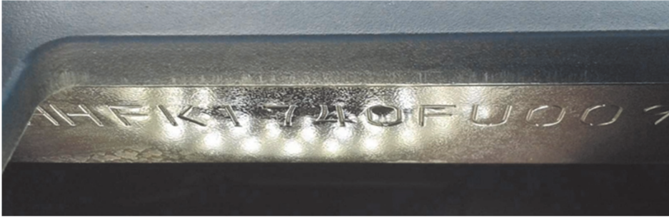
Ryc. 4. Identyfikator jest zazwyczaj niedostępny, nawet po zdemontowaniu pokrywy. Odczyt identyfikatora jest tu bardzo niewygodny, do czego przyczynia się pochyła powierzchnia.
