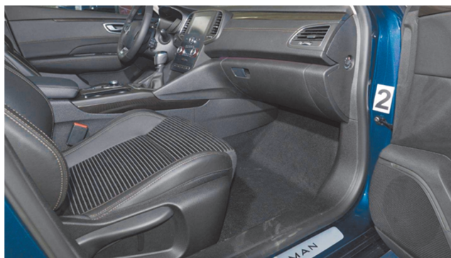
Ryc. 8. Renault Talisman. Identyfikator VIN nietypowo umieszczony pionowo w pobliżu słupka A. W takiej pozycji brud, woda i płyny eksploatacyjne nie trzymają się identyfikatora tak bardzo.
