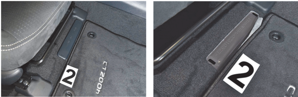
Ryc. 7. Identyfikator VIN samochodu Lexus CT 200h, standardowo umieszczony pod przednim siedzeniem pasażera. VIN zabezpiecza plastikowa osłona, chroniąca go przed uszkodzeniem i zabrudzeniem.
