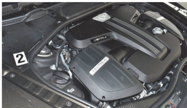
Ryc. 1. Standardowa lokalizacja identyfikatora VIN w komorze silnika samochodu Bentley Continental GT (na prawo od cyfry 2). VIN jest tu łatwo dostępny wizualnie 2 .
