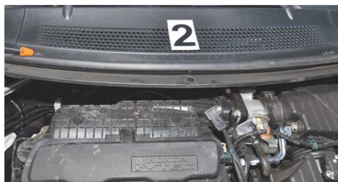
Ryc. 2. Przykład trudno dostępnego identyfikatora VIN w samochodzie Honda Civic. Aby umożliwić dostrzeżenie identyfikatora należy zdemontować plastikowe części.
