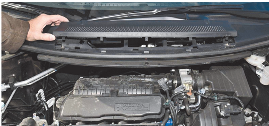
Ryc. 3. Widok zdemontowana plastikowej pokrywy przed wycieraczkami szyby czołowej.
