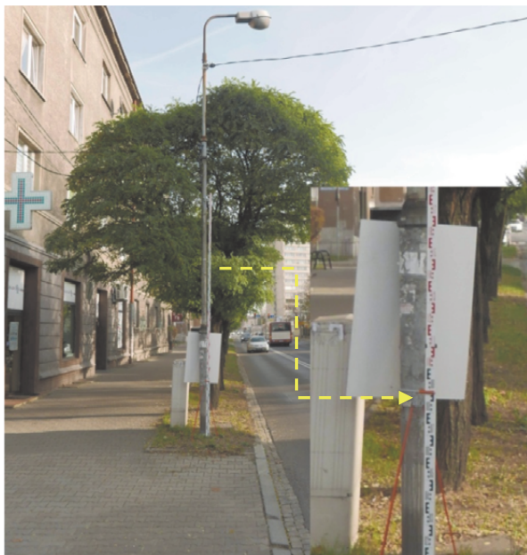
Ryc. 7. Latarnia, którą sfotografowałem z wykorzystaniem listwy pomiarowej użytej do określenia wysokości tej latarni.
