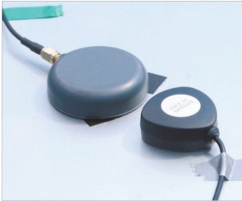
Ryc. 2. Anteny GPS zamontowane na dachu samochodu Volkswagen Passat.
