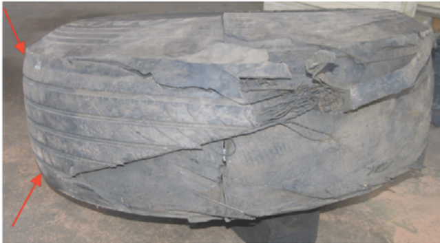
Ryc. 1. Widok rozerwanej przedniej lewej opony ciągnika Volvo. Strzałki wskazują obrzeża bieżnika zużyte bardziej niż część środkowa.
