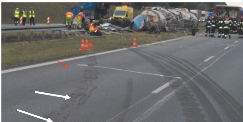
Ryc. 3. Ślady bocznego znoszenia kół zestawu. Strzałkami zaznaczony jest ślad pozostawiony przez przednie lewe koło ciągnika.
