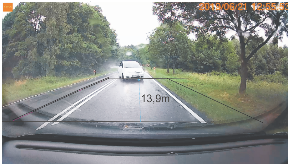
Ryc. 7. Klatka zarejestrowana w 57,056 s trwania filmu. Samochody uczestniczące w wypadku oddalone były od siebie o odległość ok. 13,9 m.
