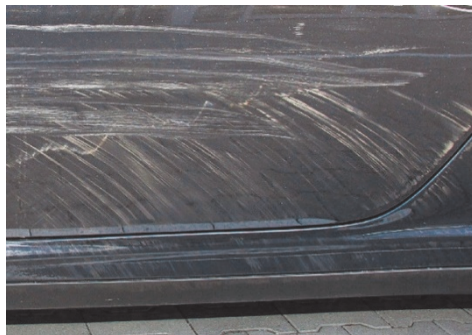
Ryc. 2. Ślady kontaktowe powstałe wskutek kontaktu z kołem na boku pojazdu.
