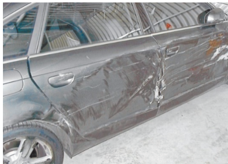
Ryc. 1. Ślady kontaktowe powstałe wskutek kontaktu z kołem na boku pojazdu.
