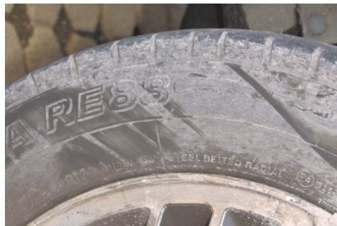
Ryc. 6. Ślady kontaktowe kół – rozrarcie warstwy zanieczyszczeń na pojeździe ocieranym (opona).
