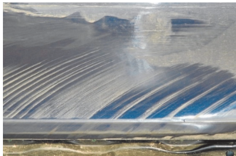
Ryc. 5. Ślady kontaktowe kół – rozrarcia warstwy zanieczyszczeń na pojeździe ocieranym (karoseria).
