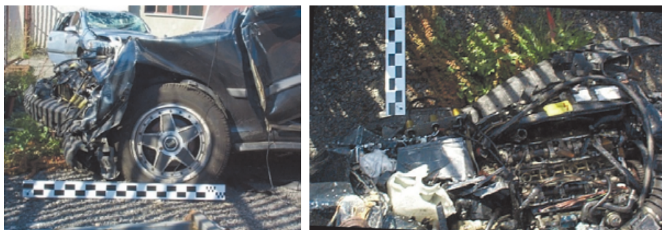
Ryc. 3. Uszkodzenie na poziomie zderzaka powstałe na skutek uderzeniu w tylne koło ładowarki kołowej.
