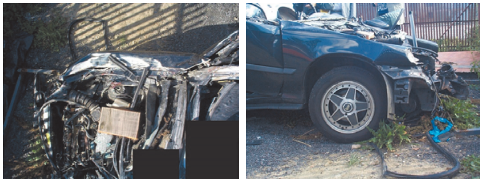
Ryc. 2. Uszkodzenia górnej części nadwozia Opla powstałe po wjechaniu pod belkę i płytę ładowarki kołowej.
