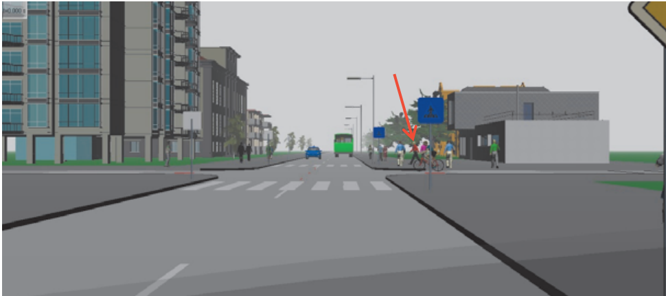
Ryc. 5. Widok z pozycji kierowcy samochodu jadącego z prędkością 50 km/h z odległości 38 m od przejścia i pieszo (w czerwonej koszuli) zbliżającego się szybkim krokiem w celu wkroczenia na przejście dla pieszych. Pieszy znajduje się ok. 3,5 m od krawędzi jezdni.
