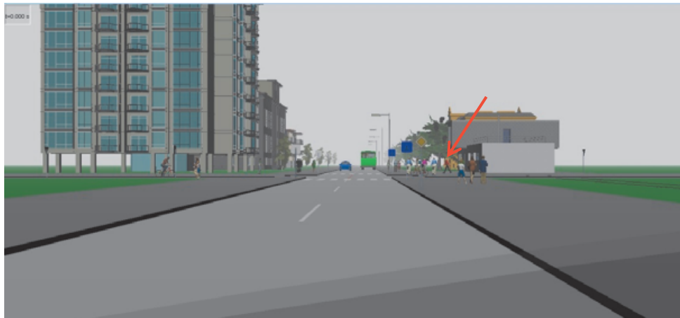
Ryc. 4. Widok z pozycji kierowcy samochodu jadącego z prędkością 70 km/h z odległości 65 m od przejścia i pieszego (w czerwonej koszuli) zbliżającego się szybkim krokiem w celu wkroczenia na przejście dla pieszych. Pieszy znajduje się ok. 7 m od krawędzi jezdni.
