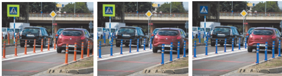
Ryc. 13. Przejście w mieście na drodze dwujezdniowej: widok dotychczasowy (po lewej), zmieniony kolor słupków znaków i słupków elastycznych, tło znaku żółte (pośrodku), dodatkowo ciemne tło znaku pogarszające jego dostrzegalność (po prawej).
