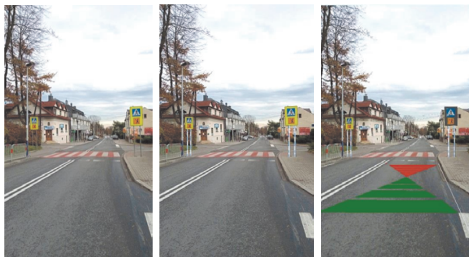
Ryc. 14. Przejście w terenie zabudowanym: widok dotychczasowy (po lewej), białoniebieskie słupki znaków (pośrodku), dodatkowo wymalowanie znaki na jezdni oraz ciemne tło znaku (po prawej).
