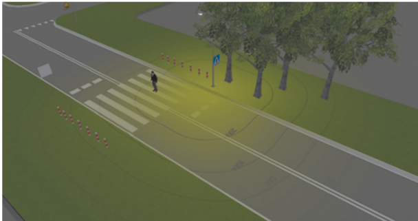
Ryc. 12. Oprawa Vektor 22 Street: krzywe rozsyłu światła (a), plama światła uzyskana w programie Dialux (b) oraz V-SIM 5.0 (c).
